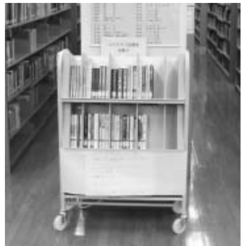
図1. インテリジェント書架 (ブックトラックへの設置例)
