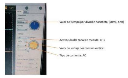
Una vez configurado el osciloscopio arrancamos el vehículo y obtenemos la señal de una forma gráfica para poder estudiarla detalladamente variando el tiempo de muestreo según se aprecia en las siguientes imágenes. Por ejemplo ver que no exista un corte o variación de voltaje entre dientes en toda la señal (crestas de la señal).
