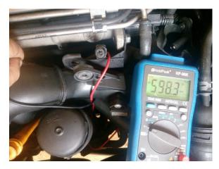
Con osciloscopio, conectamos las puntas de prueba al conector del sensor, igual que con el multímetro,(conector desenchufado) o pinza negra a borne negativo batería y pinza positivo a un conector del sensor (conector enchufado). Seleccionamos en el programa: canal de medida (canal 1), tipo de corriente (AC) tiempo por división, 20ms (1º imagen) o 5ms (2º imagen), voltaje por división (5v)
