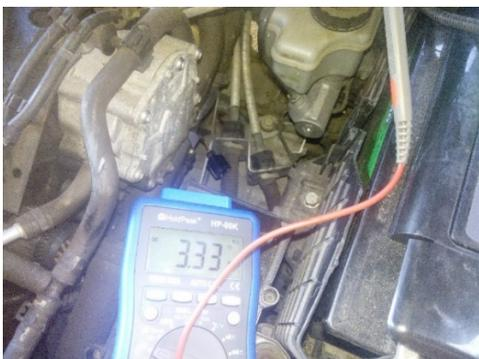
**3º paso:** Comprobar la continuidad de la instalación desde el sensor hasta la unidad de control. Para ello conectar la pinza negra del óhmetro al conector de la unidad de control motor y la roja al conector del sensor (valor inferior a 30Ω).
