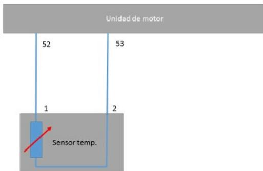
Sensor de temperatura doble: Es un tipo de sensor muy utilizado hoy en día. Se trata de un sensor que incorpora dos sondas independientes para enviar información al cuadro de instrumentos y a la unidad de motor de forma independiente. El conector está compuesto por cuatro pines
