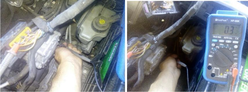
**4º paso:** Comprobar el aislamiento entre los cables del sensor y masa del vehículo con el conector de la unidad motor desconectado. (Valor > 30MΩ). Para ello conectar la pinza negra del sensor a masa y la pinza roja a los pines del conector.
