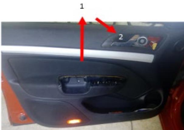
**10º paso:** El revestimiento quedará sujeto por los cables de la luz interior de la puerta, el altavoz de agudos, el piloto del cierre centralizado y el cable de apertura interior de puerta, los cuales habrá que soltar con cuidado para no romper los terminales.
