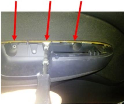
**5º paso:** Sacar los dos tornillos de la parte inferior del revestimiento.
