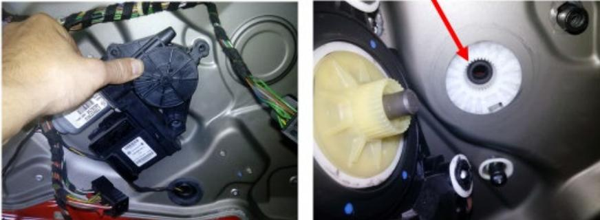
El montaje de la unidad nueva y el revestimiento se hará de la forma inversa al desmontaje.
