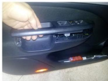
3º paso: Soltar el conector de bloque de interruptores de elevavinas de puerta tirando del clip de desbloqueo hacia atrás.
