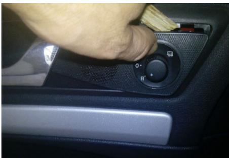
**7º paso:** Sacar el tornillo de sujeción del revestimiento, que está ubicado en el interior de la tapa.
