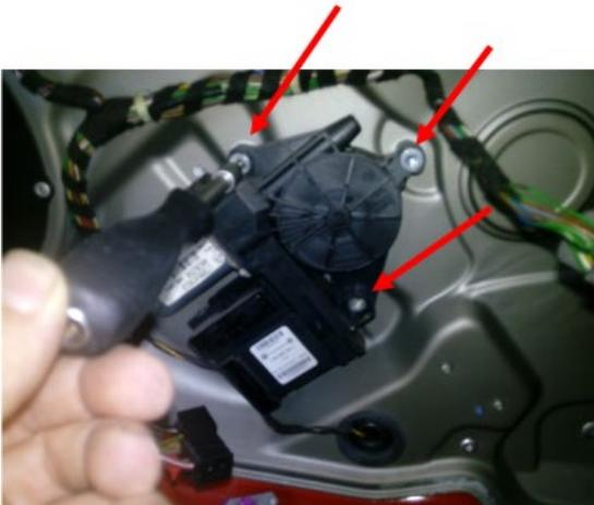
**3º paso:** Soltar la unidad de puerta con las manos. Revisar el estriado del mecanismo del elevavinas antes de montar la unidad nueva por si presenta deterioro en el mismo.
