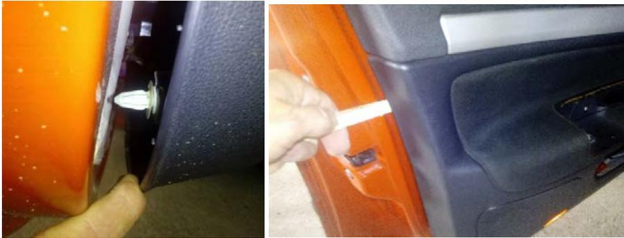
**9º paso:** Soltar el revestimiento tirando de él hacia arriba y hacia a dentro después con cuidado según las flechas de la siguiente imagen.
