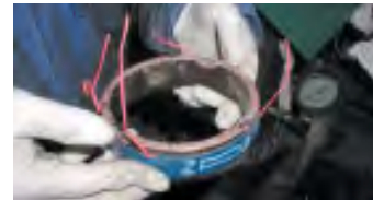
複数ノズルアブレシブジェットシステムで穿孔した鋼管」(研究成果等3)
