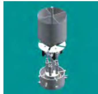
「複数ノズルを有するアブレシブウォータージェットシステムの外観」(研究成果等3)
