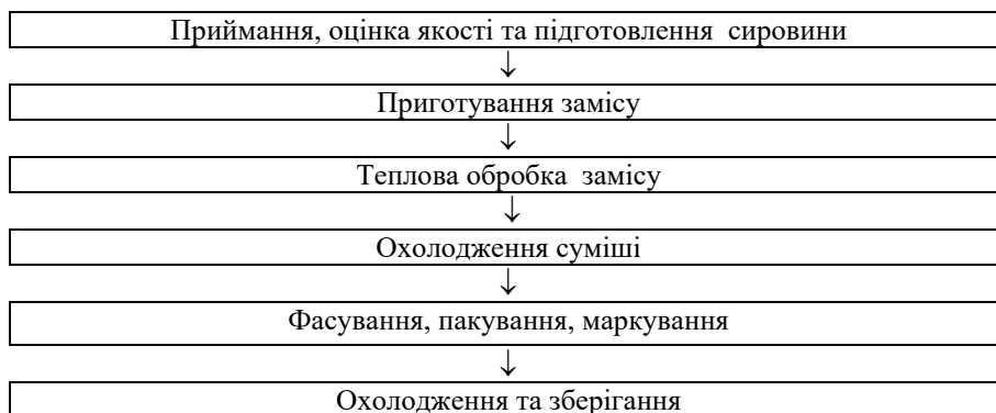
Рис. 2. Технологічна схема виробництва сиркової пасти з пюре кореня селери
