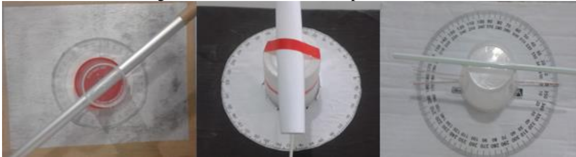
Figura 7 – teodolito construído pelos alunos.
