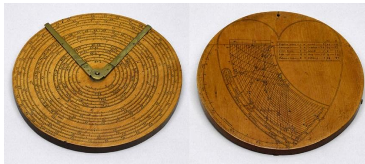
Figura 2 – Régua de Cálculo Circular, 1660-1680
