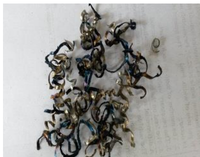
s=710\text{mm/min} , f=0.063\text{mm/rev} & d=1\text{mm}
