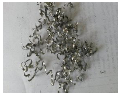
s=180\text{mm/min} , f=0.063\text{mm/rev} & d=1\text{mm}
