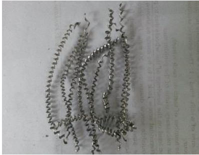
s=180\text{mm}/\text{min} , f=0.063\text{mm}/\text{rev} & d=1\text{mm}
