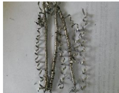
s=710\text{mm/min} , f=0.09\text{mm/rev} & d=1.5\text{mm}
