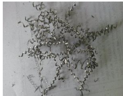
s=450\text{mm}/\text{min} , f=0.063\text{mm}/\text{rev} & d=2.5\text{mm}
