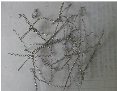
s=450\text{mm}/\text{min} , f=0.125\text{mm}/\text{rev} & d=2\text{mm}
