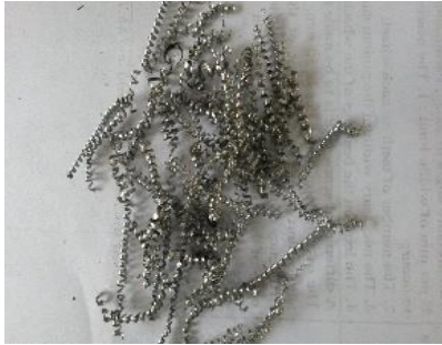
s=112\text{mm/min} , f=0.05\text{mm/rev} & d=1.5\text{mm}
