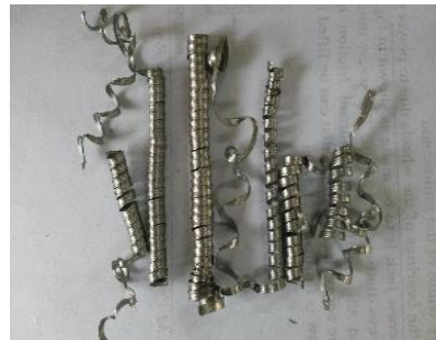
s=280\text{mm}/\text{min} , f=0.045\text{mm}/\text{rev} & d=1.5\text{mm}
