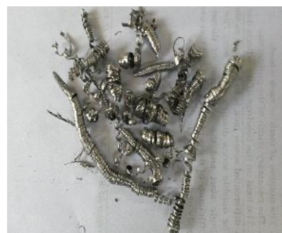
s=112\text{mm}/\text{min} , f=0.09\text{mm}/\text{rev} & d=0.5\text{mm}
