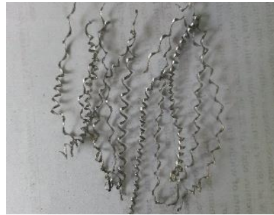
s=450\text{mm/min} , f=0.063\text{mm/rev} & d=1\text{mm}
