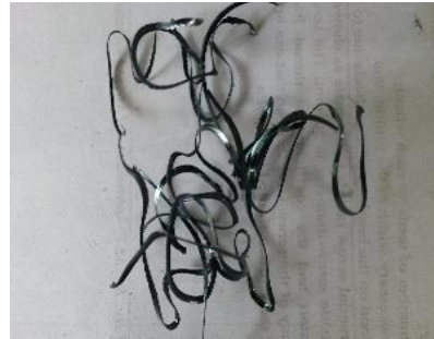
s=180\text{mm/min} , f=0.063\text{mm/rev} & d=1\text{mm}
