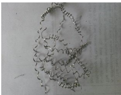
s=180\text{mm/min} , f=0.063\text{mm/rev} & d=1\text{mm}
