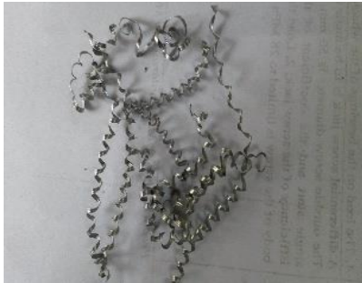
s=180\text{mm/min} , f=0.063\text{mm/rev} & d=2\text{mm}
