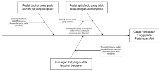
Gambar 18: Diagram tulang ikan untuk cacat perbedaan tinggi pada pertemuan foil
