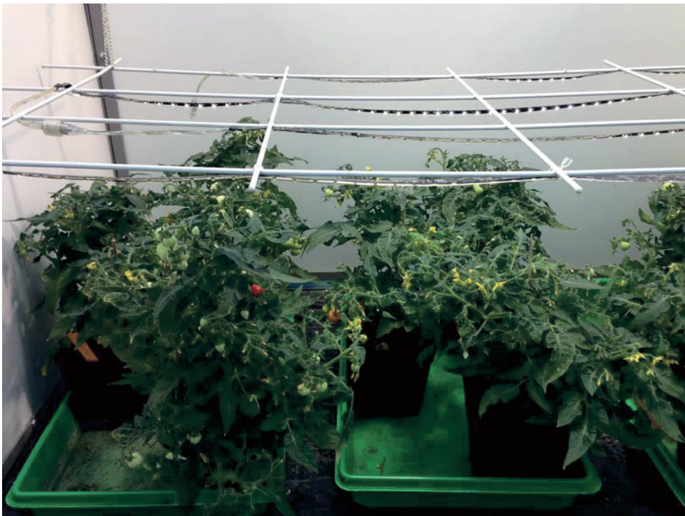
Abb. 4. Pflanzenanordnung in Versuchsbox, LED-Aufhängung pflanzennah.
