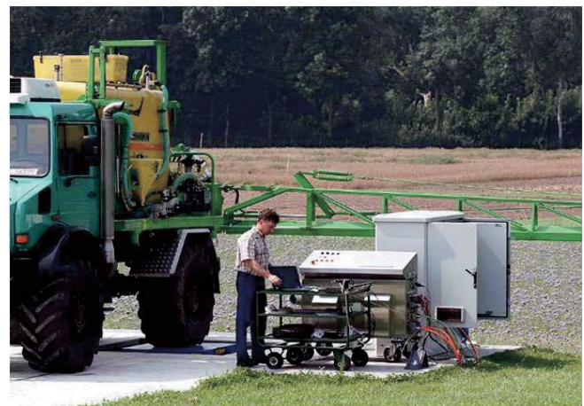
Abb. 5. Aufbau-Feldspritzgerät auf dem Schwingungsprüfstand.
