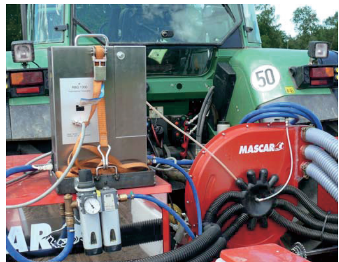
Abb. 2. Staubdosierer zur definierten Einspeisung eines fluoreszierenden Farbstoffes in die Ansaugöffnung des Gebläses.
