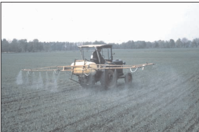
Abb. 1. Feldspritzgerät im praktischen Einsatz, das offensichtlich erhebliche technische Mängel aufweist.
