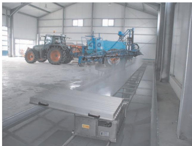
Abb. 5. Technische Überprüfung eines Feldspritzgerätes (vergleichbar mit der HU bei Kraftfahrzeugen): Verteilungsmessung mittels eines elektronischen Prüfstandes; hierbei wird das verspritzte Wasser aufgefangen und wieder in den Gerätetank zurückgeführt.
