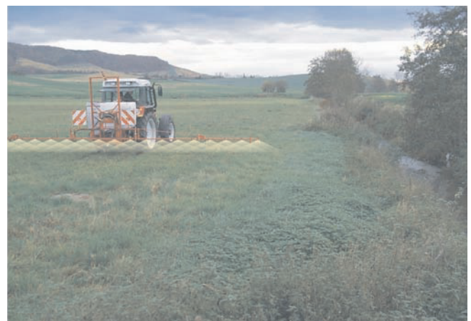
Abb. 2. Modernes Feldspritzgerät, ausgestattet mit Flachstrahldüsen, die sich durch eine gute Verteilungsqualität und geringe Abdrift auszeichnen.
