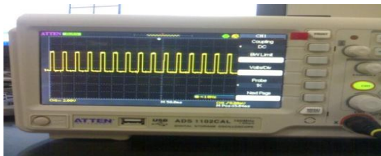
Gambar 7. Hasil Pengukuran Pulsa DC Chopper kecepatan ke -3 menggunakan osiloskop
