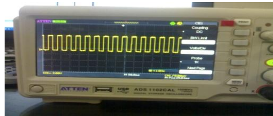
Gambar 9. Hasil Pengukuran Pulsa DC Chopper kecepatan ke-5 menggunakan osiloskop.
