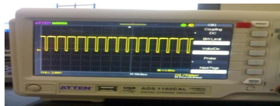
Gambar 11. Hasil Pengukuran Pulsa DC Chopper kecepatan ke-7 menggunakan osiloskop
