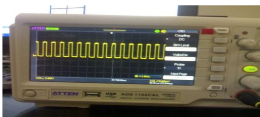
Gambar 8. Hasil Pengukuran Pulsa DC Chopper kecepatan ke-4 menggunakan osiloskop.
