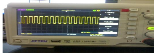
Gambar10. Hasil Pengukuran Pulsa DC Chopper kecepatan ke-6 menggunakan osiloskop
