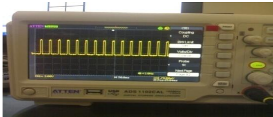
Gambar 6. Hasil Pengukuran Pulsa DC Chopper kecepatan ke-2 menggunakan osiloskop
