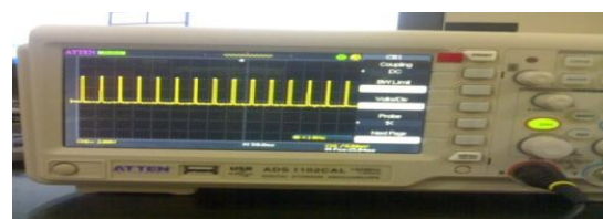
Gambar 5. Hasil Pengukuran Pulsa DC Chopper kecepatan ke-I menggunakan osiloskop
