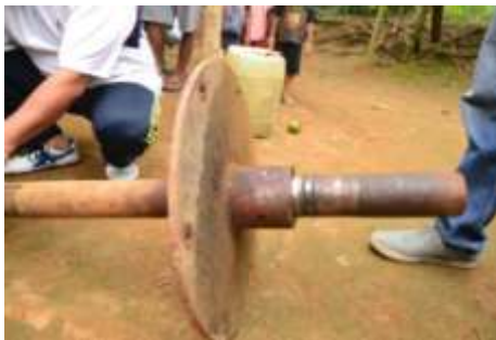
Gambar 4. Poros turbin yang rusak dan telah dilepas
