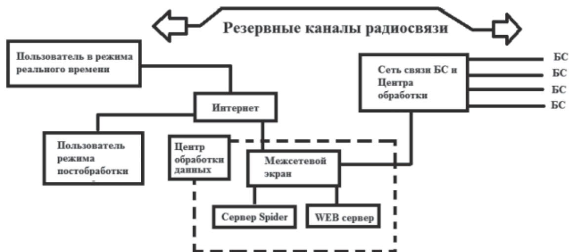
Рис. 11. Общий принцип работы базовых станций
