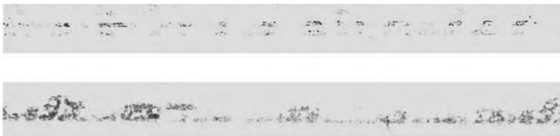
Рис. 9, 10. Поверхностные следы бумагопроводящих роликов принтера Samsung SCX-424
