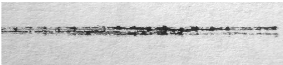
Рис. 1. Фрагмент видимого поверхностного следа детали БПМ струйного принтера HP DeskJet 1000 на листе бумаги
