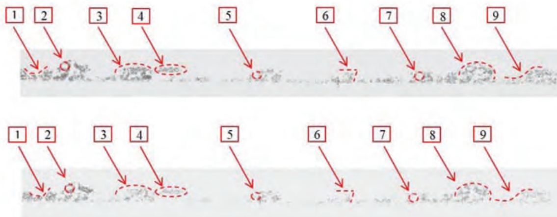
Рис. 6. Поверхностные следы бумагопроводящих роликов лазерного принтера Samsung SCX-424 (стрелками одноименными цифрами отмечены совпадающие частные признаки)
