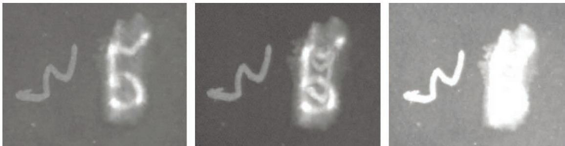
Рис. 12. Фотосъемка ИК-люминесценции при различном накоплении сигнала: 8 ms (слева), 24 ms (в центре), 75 ms (справа)
