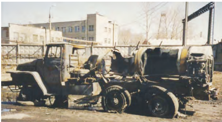
Рис. 12. Состояние топливозаправщика после взрыва и пожара на СНЭ Московской нефтебазы
