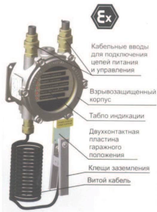
Рис. 4. Блок заземления автоцистерн (БЗА) конструкции ОАО "ПРОМПРИБОР" [8].
