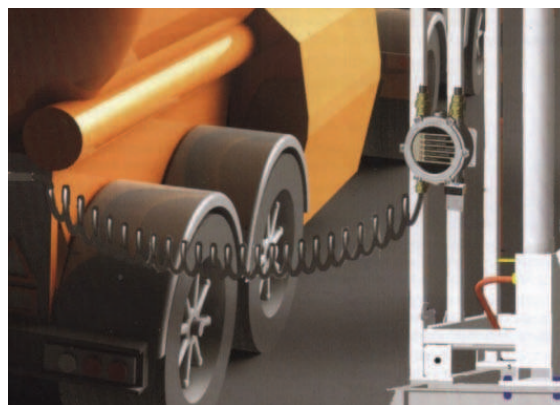
Рис. 3. Заземление автоцистерны конструкции ОАО "ПРОМПРИБОР"[8].
