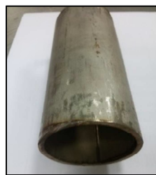
a. 304L SS pipe
