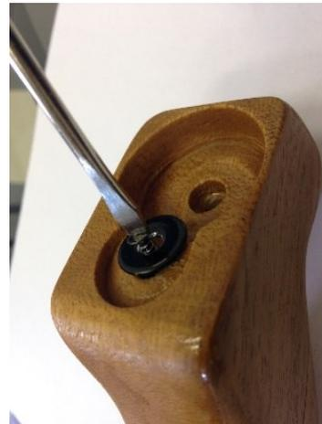
Figura 21- Arruela sendo parafusada
