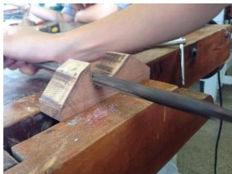
Figura 17- Desbaste da superfície interna com a grossa
