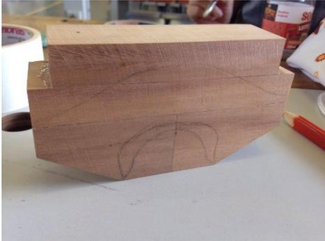
Figura 93- Corte de 45° no bloco de madeira
