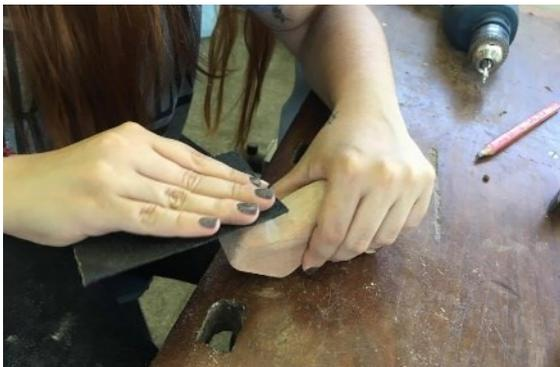
Figura 19- Lixamento da peça com lixa 150
