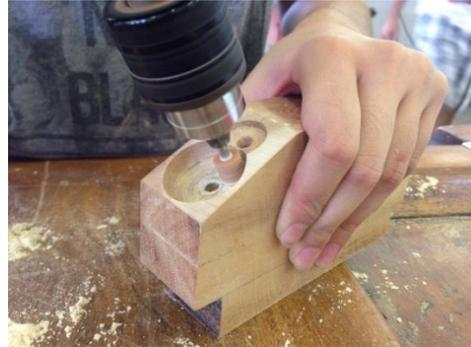
Figura 11- Lixamento da parte interna dos furos
