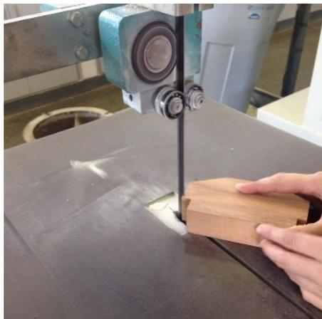
Figura 14- Corte na serra de fita
