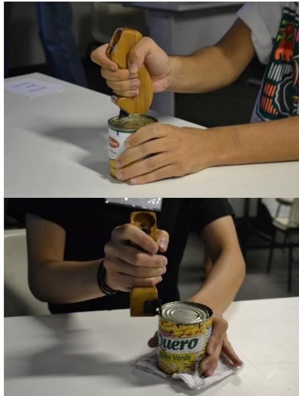
Figura 23 – Teste de usabilidade do protótipo. Fonte: Imagem gerada pelas autoras, 2017.
