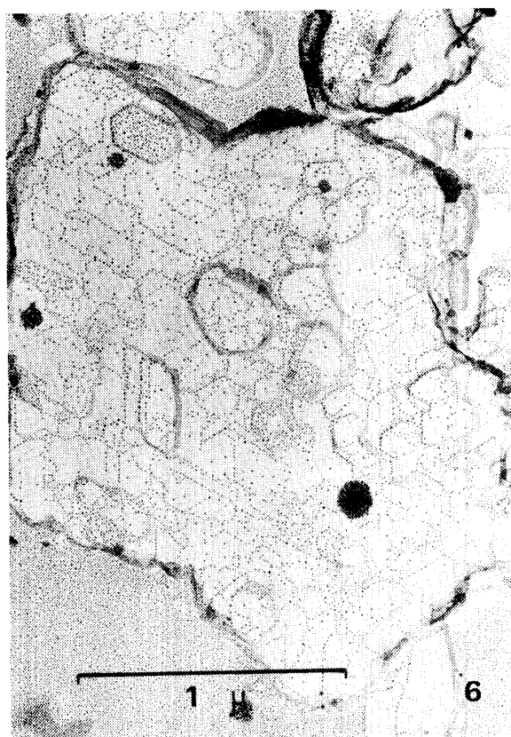
写真 6. 瀬戸蛙目粘土 (SG) の表面に見られた成長ステップ
