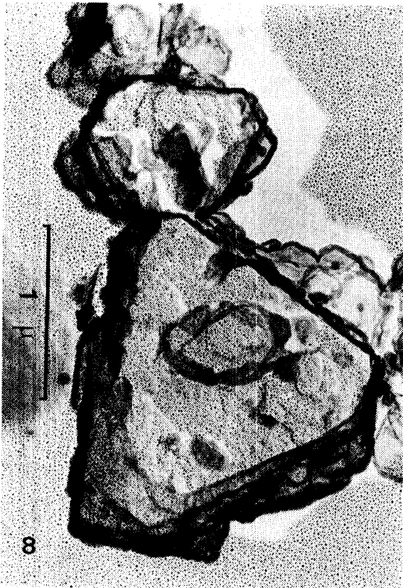
写真 8. 関白カオリン・腐植酸複合体の表面(腐植酸吸着量 6.2g 炭素/100g 粘土)
