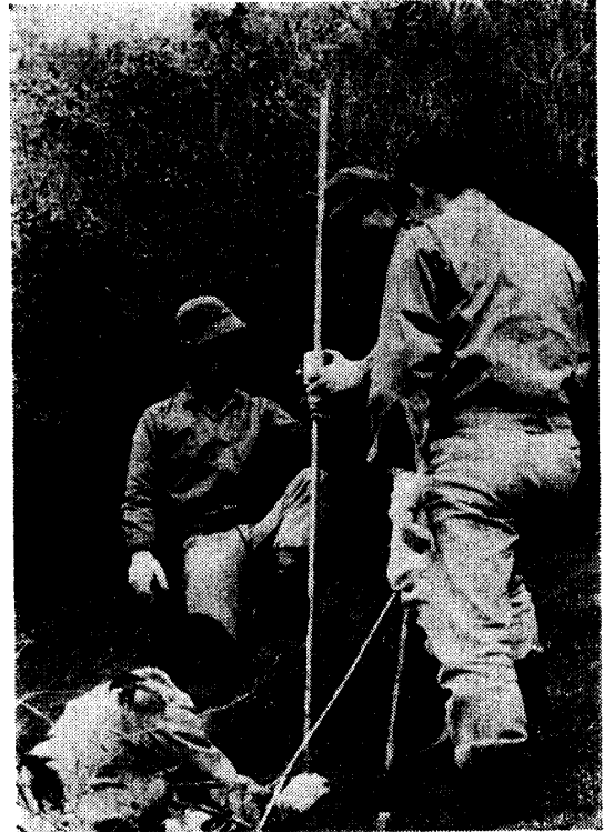
写真-4 現地での土研式貫入試験機によるサウンディング試験
