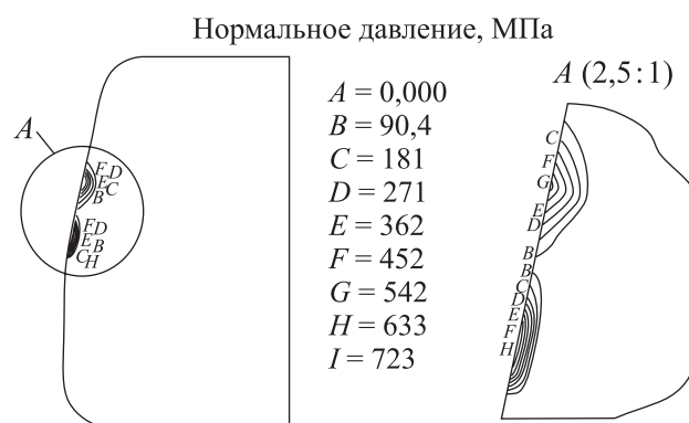
Рис. 6. Линии равного уровня распределения нормального давления в рабочем канале волоки
