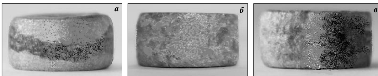
Рис. 4. Внешний вид иридиевых образцов, осажденных при t = 1000\text{ }^{\circ}\text{C} со скоростью 0,2 (а), 2,0 (б) и 20\text{ c}^{-1} (в)
