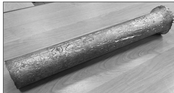
Рис. 10. Внешний вид отливки электрода из наномодифицированного жаропрочного сплава на основе NiAl
