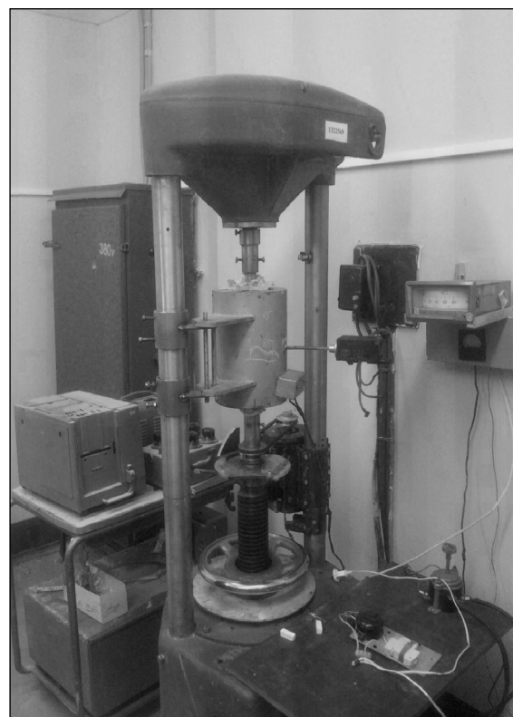
Рис. 2. Внешний вид лабораторного торсионного пластометра
