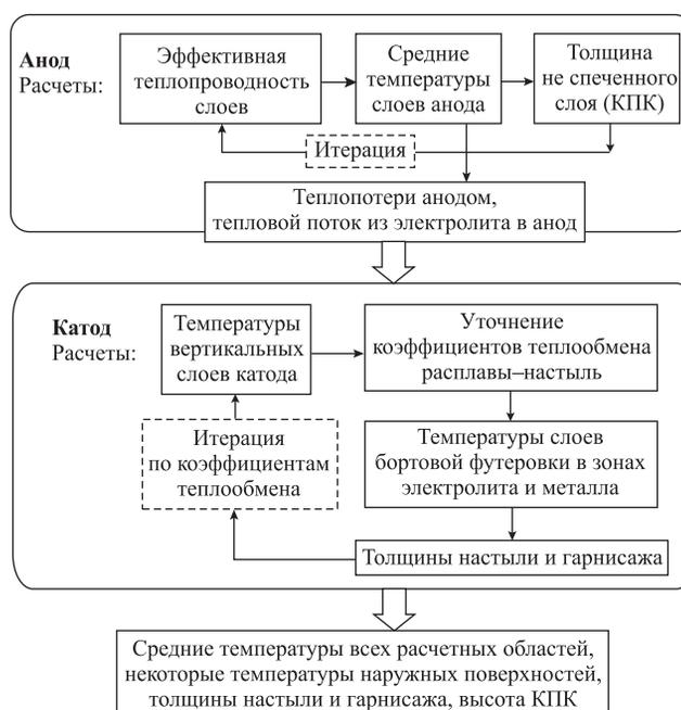
Рис. 3. Схема расчета стационарного состояния и начальных условий
