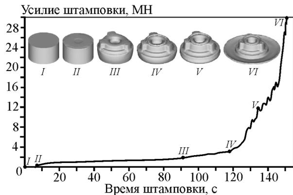
**Рис. 7.** Изменение усилия штамповки и формы заготовки при моделировании штамповки в открытом штампе
