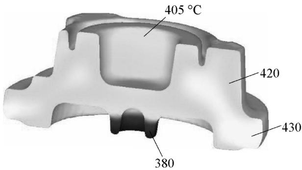
**Рис. 4.** Модель изменения формы заготовки и распределение температуры по ее объему в процессе штамповки в закрытом штампе
