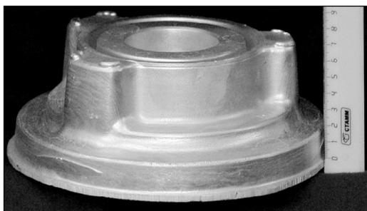
Рис. 1. Штампованная поковка «Крышка» из сплава АК6
