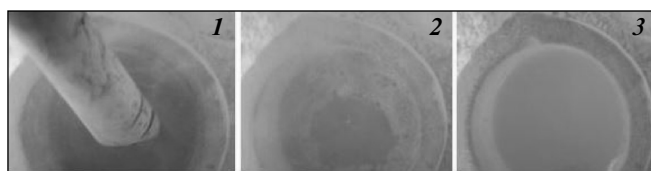
Рис. 3. Состояние поверхности расплава при KO = 2,2
