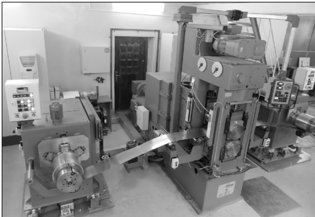
Рис. 2. Лабораторный комбинированный стан К 220-75/300 (Д240/300)
