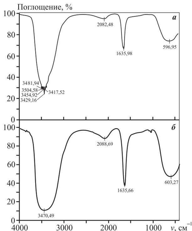
Рис. 1. ИК-спектры комплексов ионов  $\text{Cu}^{2+}$  с дибутилдифосфатом калия (а) и бутиловым ксантогенатом калия (б) ( $\text{M} : \text{L} = 1 : 1$ )
