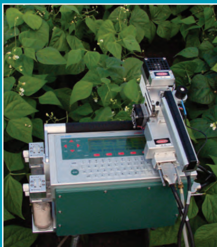
Рис. 2. Портативный газоанализатор Li-6400 XT (фирма Li-COR, США) для изучения интенсивности фотосинтеза и транспирации. Fig. 2. Portable gas analyzer Li-6400 XT (Li-COR, USA) to study the intensity of photosynthesis and transpiration.
