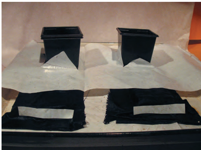
Рис.4. Фрагмент матрицы для выращивания растений томата и огурца с частью П-образной подложки, покрытой слоем капроновой ткани (фитильной системы).
