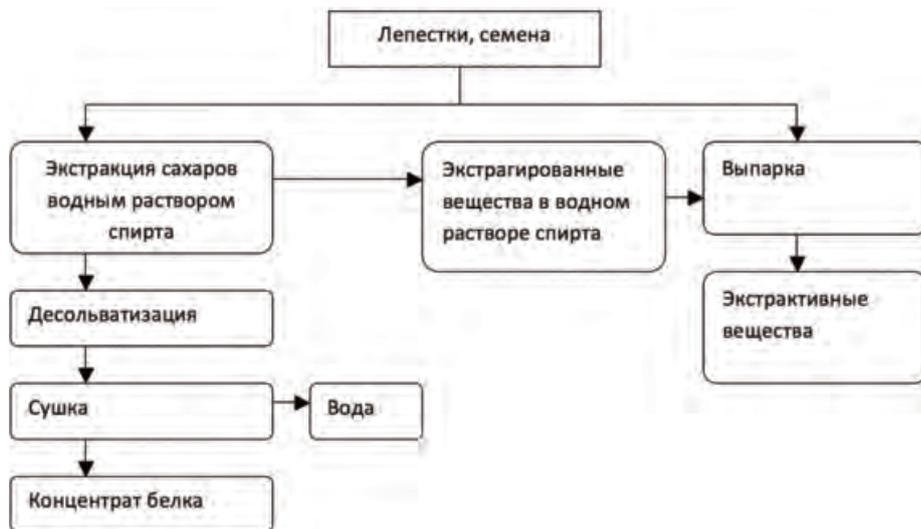
Рис. 2. Схема производства концентратов методом спиртовой экстракции.
