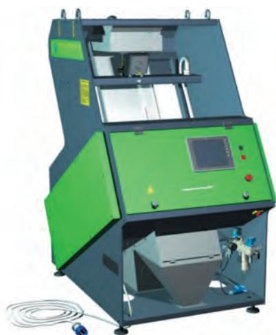
Рис. 1. Внешний вид рабочего макета рентгенсепаратора на основе фотосепаратора Ф-5
