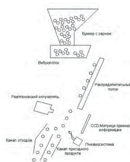
Рис. 3. Схема организации потоков сканирования
