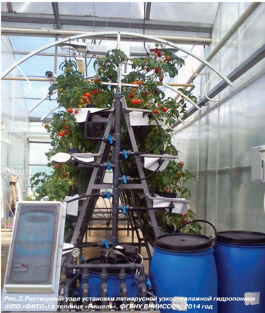
Рис.2. Растворный узел установки пятиярусной узкостеллажной гидропоники (НПО «ФИТО») в теплице «Ришель». ФГБНУ ВНИИССОК, 2014 год
