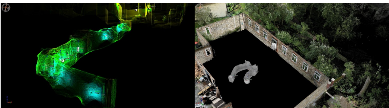
Abb. 4: links: dreidimensionale Punktwolke des Erdkellers, mit dem „Reflectance“-Wert eingefärbt. rechts: Punktwolke der ober- und unterirdischen Vermessung, mit Echtfarbe eingefärbt
