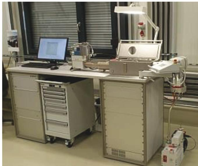
Abbildung 41 – Ansicht eines Abschreck- und Umformdilatometers „DIL 805 A/D“
