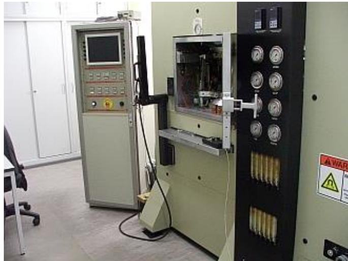
Abbildung 44 – Ansicht des Prüfsystems „Gleeble HDS-V40“
