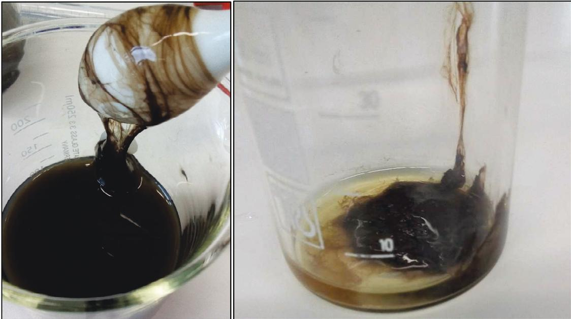
**Abbildung 40: Konsistenz beim Einrühren des kationischen Polymers CP 24 V in den Gärrest,  $c_{\text{Polymer}} = 0,3 \text{ g/L}$**
