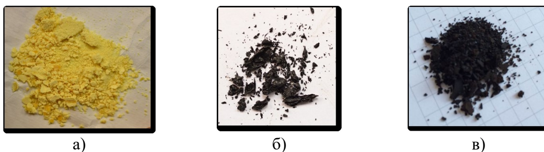
Рисунок 2.4 – Выделенные из нефти компоненты: а) твердые парафины, б) смолы, в) асфальтены
