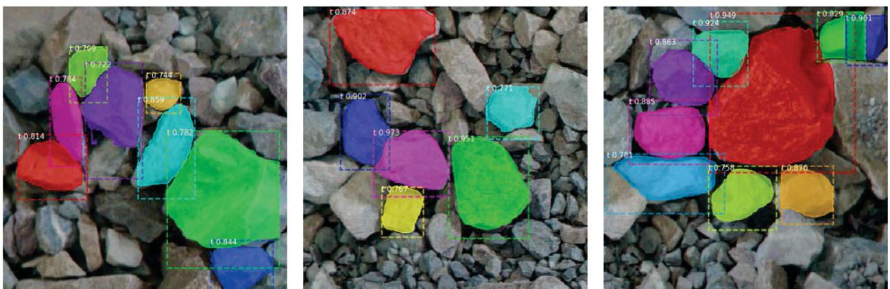
Abb. 4: Erste Segmentierungsversuche mit wenigen Trainingsdaten. Steine in Farbe mit Begrenzungsboxen und Konfidenzwerten.
