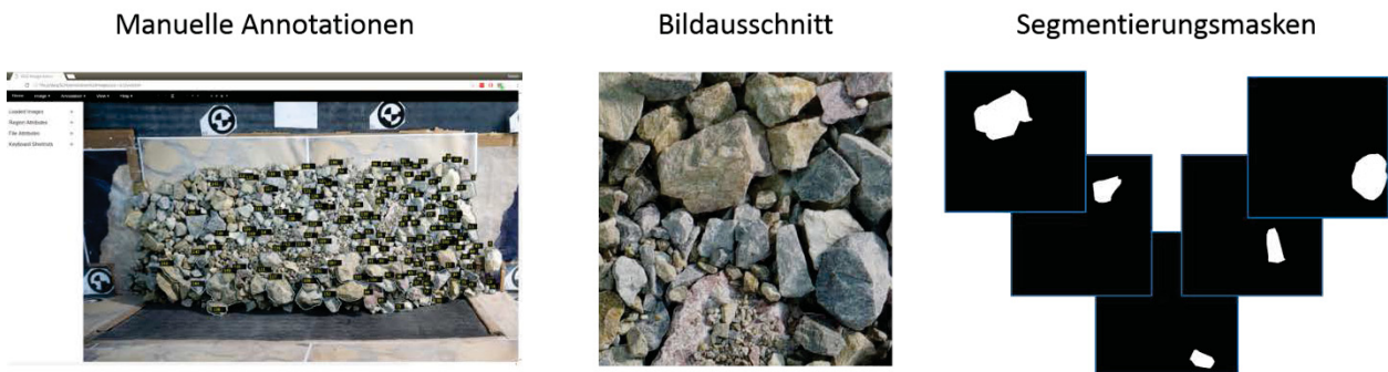
Abb. 3: Generierung der Trainingsdaten für das CNN. Manuelle Annotation von individuellen Steinen in einem Bild. Der daraus extrahierter Bildausschnitt und die zugehörigen Segmentierungsmasken werden für das Training des CNNs genutzt.
