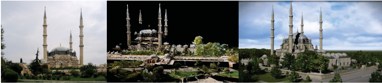
Abb. 4: Selimiye-Moschee von Edirne, Türkei – Foto (links), kolorierte Punktwolke (Mitte) und 3D-Modell (rechts)
