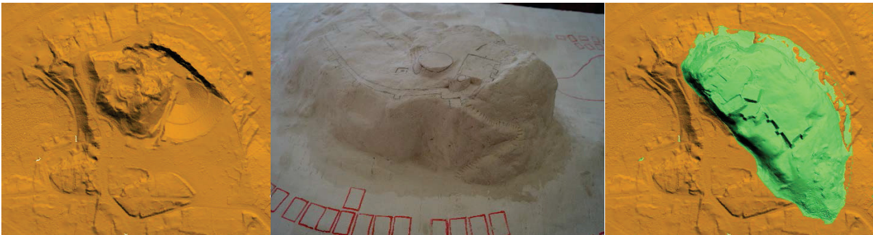
Abb. 6: Rekonstruktion des historischen Kalkberges in Bad Segeberg – 3D-Geländemodell aus airborne Laserscanning (links), rekonstruierter historischer Kalkberg als Gipsmodell (Mitte) und mit photogrammetrischen Verfahren abgeleitetes historisches Modell (grün) als Überlagerung des aktuellen Geländemodells (rechts)
