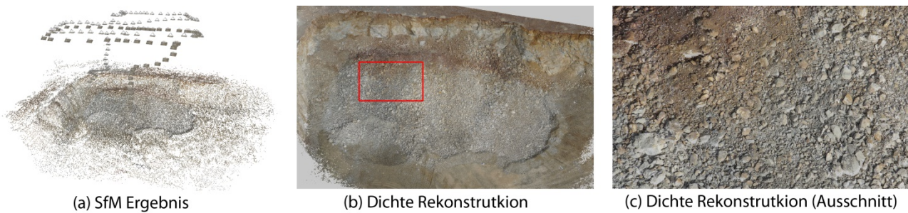
Abb. 2: 3D Rekonstruktionsergebnis. (a) Das Structure-from-Motion (SfM) Ergebnis enthält eine dünne Punktwolke und die Kameraposen. (b) Nach dem Multi-View Stereo Schritt wird die Punktwolke wesentlich dichter und enthält Millionen von Punkten. Das rote Viereck markiert den Ausschnitt (c).
