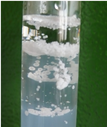
Abb. 7-23: Fotografische und lichtmikroskopische Aufnahmen von im Gel gewachsenem Ba-DTPMP (Probe aw_173)
