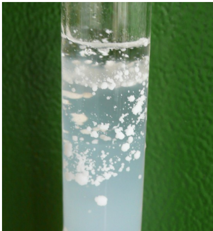
Abb. 7-18: Fotografische und lichtmikroskopische Aufnahmen von im Gel gewachsenen Sr-DTPMP-Kristallen (Probe: aw_148)
