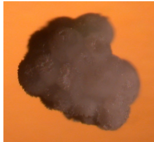
Abb. 7-18: Fotografische und lichtmikroskopische Aufnahmen von im Gel gewachsenen Sr-DTPMP-Kristallen (Probe: aw_148)
