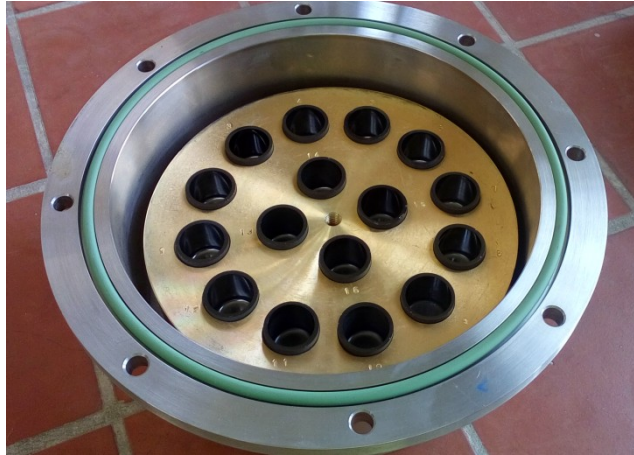
Abb. 7-15: Fotografische Aufnahme des Autoklaven zur solvothermalen Kristallzüchtung
