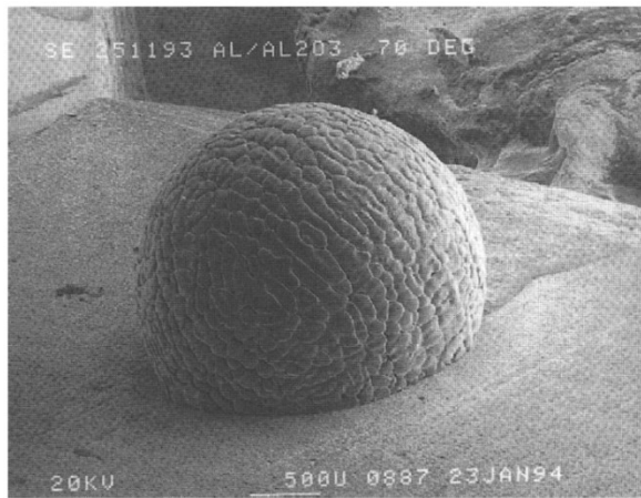
Abb. 2.2: Benetzung von Metallschmelzen: a) Rasterelektronenmikroskop-Aufnahme eines Aluminiumtropfens ( d < 2 \text{ mm} ) auf Aluminiumoxid (Zhou und Hosson 1995); b) Modellvorstellung der zurückziehenden Flüssigkeit aus dem Partikel / Filter Kontaktbereich (Hammerschmid und Janke 1988).
