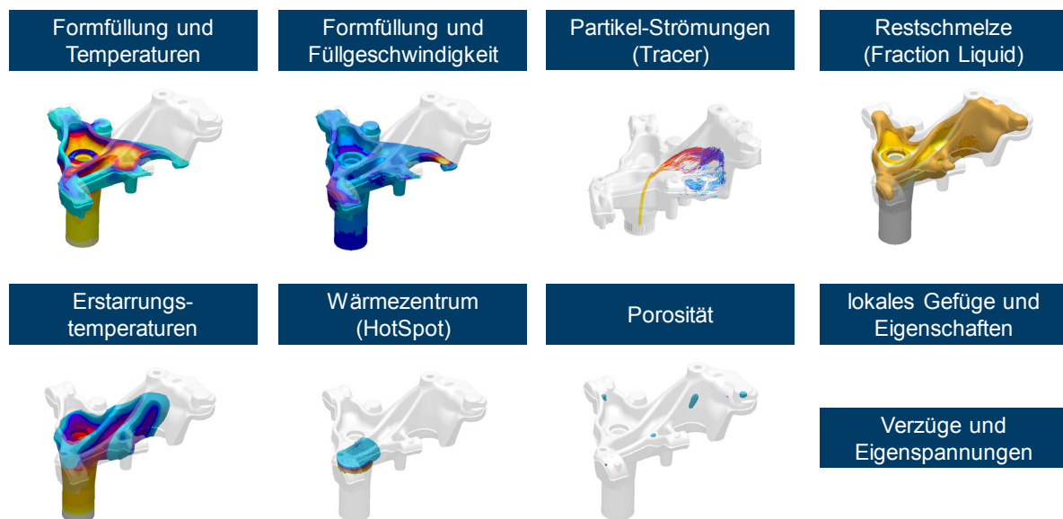
Abbildung 2-11: Wichtige Möglichkeiten und Einsatzgebiete der Gießsimulation bei der Herstellung von gegossenen Fahrwerk-Komponenten aus Aluminium
