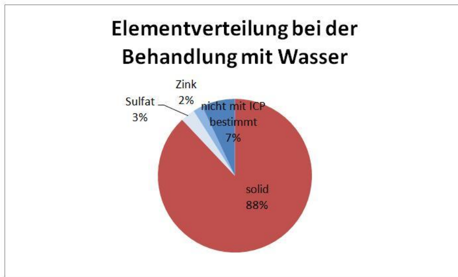
Abbildung 15: Massebilanz der Behandlung von Theisenschlamm mit Wasser
