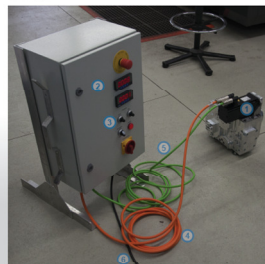
1 Erregerzelle mit 2 Leistungselektronik 3 Drehzahlleistung (grob u. fein), 4 Leistungskabel, 5 Datenkabel, 6 Stromanschluss 230V 16A (alle Fotos vom 22.04.2015)
