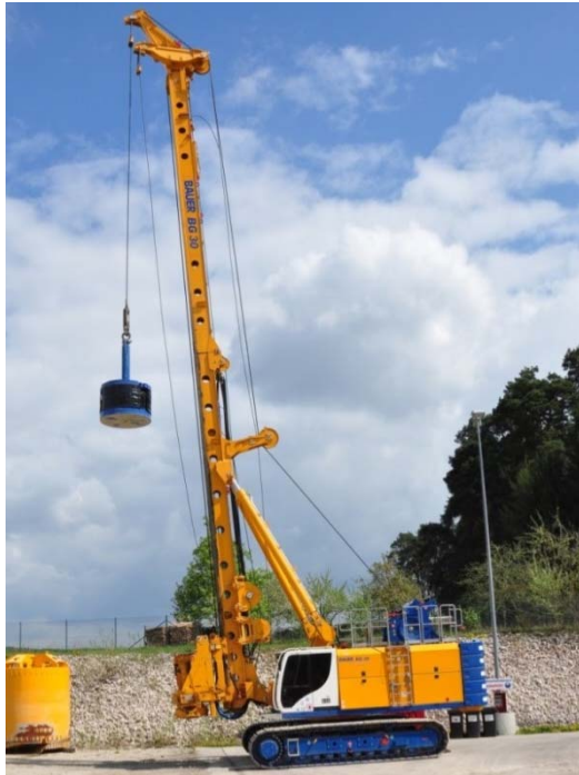
Abb. 5: Bauer BG 30 PremiumLine beim Windentest
