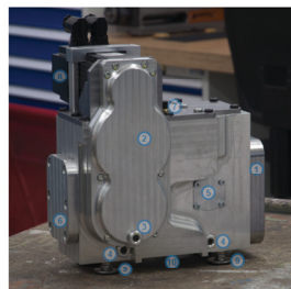
Vorderansicht: 1 Ausgleichsmasse, 2 Deckel Getriebestufe I mit 3 Öltschauglas, 4 Öltschaugläser Stufe II, 5 Lagerdeckel Welle 3, 6 seitlicher Zugangsdeckel, 7 Beiliftung, 8 Antriebsmotor, 9 temporäre Füße, 10 Montagepunkt für Rammgut
