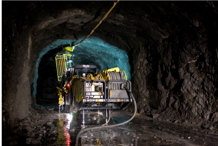
Abb. 5: Produktionsbohrgerät Simba mit wasserbetriebenen Senk-Bohrhämmer (Foto: Atlas Copco)
