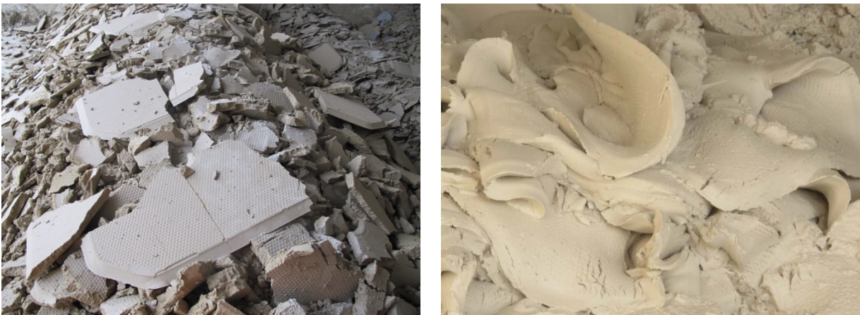
Abb. 8: Filterkuchen mit niedrigem (links) und erhöhtem Wassergehalt nach dem Auswurf
